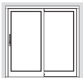
Verschlussstellung: Flügel geschlossen und verriegelt
